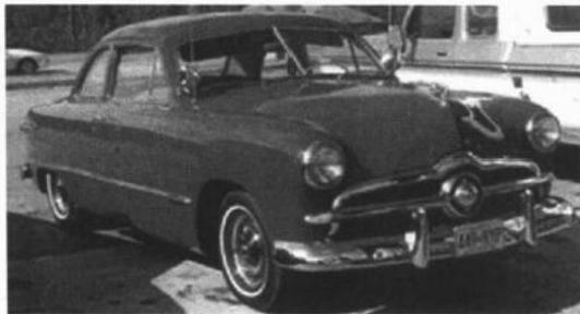
福特V8型汽车的成功，不仅仅在外形上有所突破，而且把人机工程学应用在汽车的设计上。强调以人为主体的设计思想，让设计师置身于驾驶员及乘员的位置来设计便于操纵、乘坐舒适的汽车。船型汽车无论从外形还是从性能来看都优于甲壳虫型汽车，并且解决了甲壳虫型汽车的横风不稳定问题。船型汽车发动机前置，汽车重心相对前移，而且加大了行李舱，造成风压中心位于汽车重心之后，使船型汽车遇到横风时不会侧偏。
