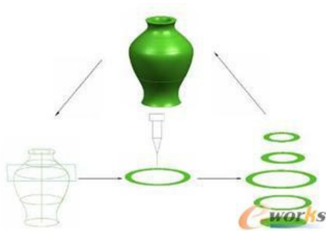
图1 快速成型技术基本原理
