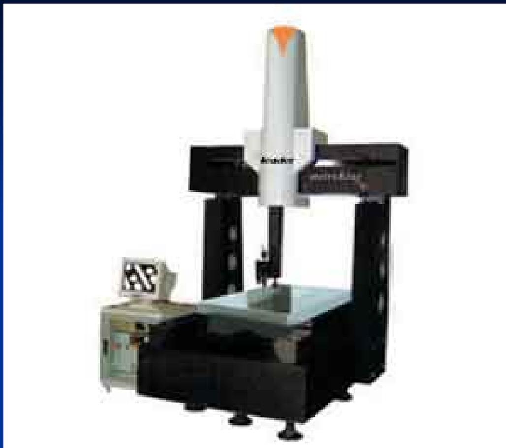
三坐标测量机配影像测头
