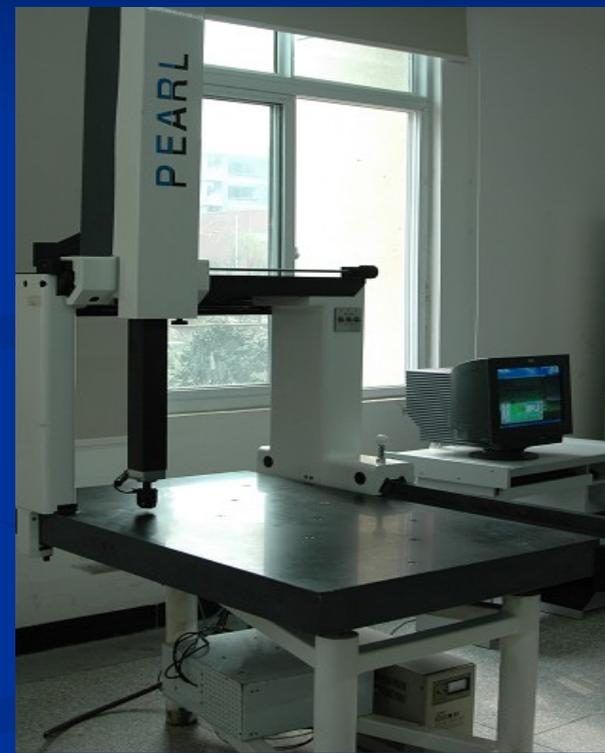
■ 测量机的采点发讯装置是测头，在沿 X，Y，Z 三个轴的方向装有光栅尺和读数头。其测量过程就是当测头接触工件并发出采点信号时，由控制系统去采集当前机床三轴坐标相对于机床原点的坐标值，再由计算机系统对数据进行处理和输出。因此测量机可以用来测量直接尺寸，也可以获得间接尺寸和形位公差及各种相关关系，也可以实现全面扫描和一定的数据处理功能，为加工提供数据和测量结果。自动型还可以进行自动测量，实现批量零件的自动检测。
