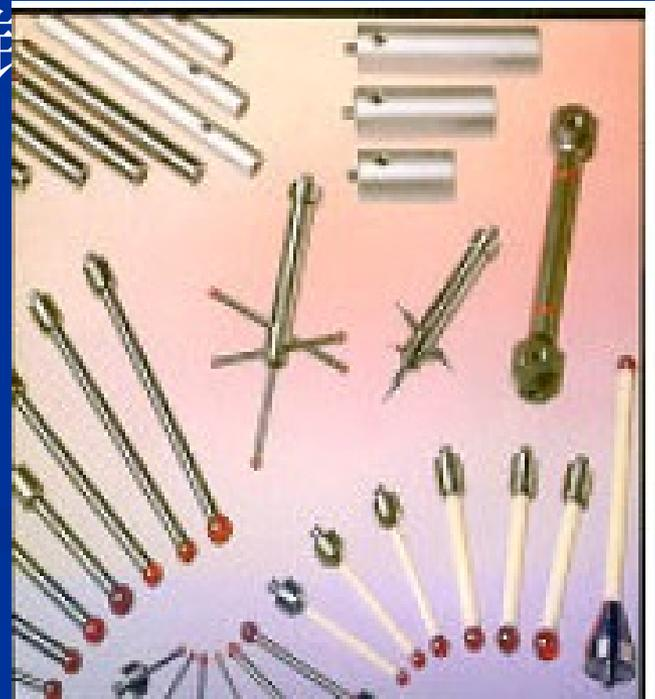
3) 连接器：为了将探针连接到测头上、测头连接到回转体上或测量机主轴上，需采用各种连接器。常用的有星形探针连接器、连接轴、星形测头座等。
