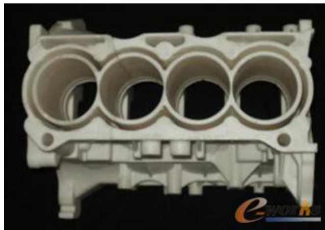
图9 采用 SLS 技术生成的4缸发动机
