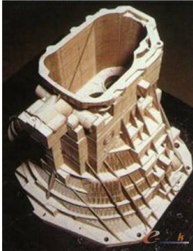
图 10 运用 LOM 快速原型系统所制作出几何形状复杂之原型件
