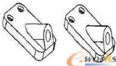
图 3 制件产生翘曲变形
