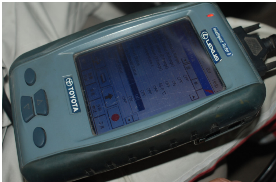
图 5 丰田 Tester II 专用解码仪
