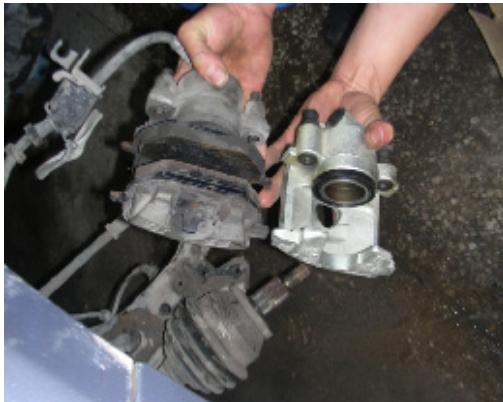
后来经过反复的试车，等我们想把原车的悬挂全部换回的时候，发现左前轮轮辋微微发热，而其他的轮辋均是凉的。恍然大悟，是不是左前轮刹车分泵回位不良，造车制动拖滞，以至于行驶中，左前轮一直存在部分制动，造成的？
