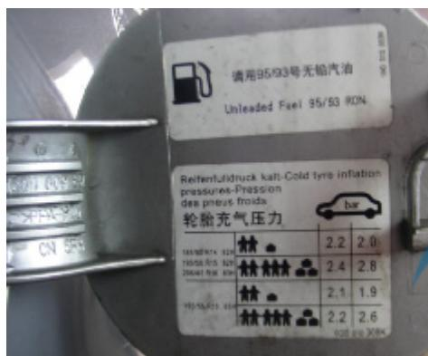
造成新车跑偏的大都是轮胎气压问题，首先对轮胎的气压进行测量。
