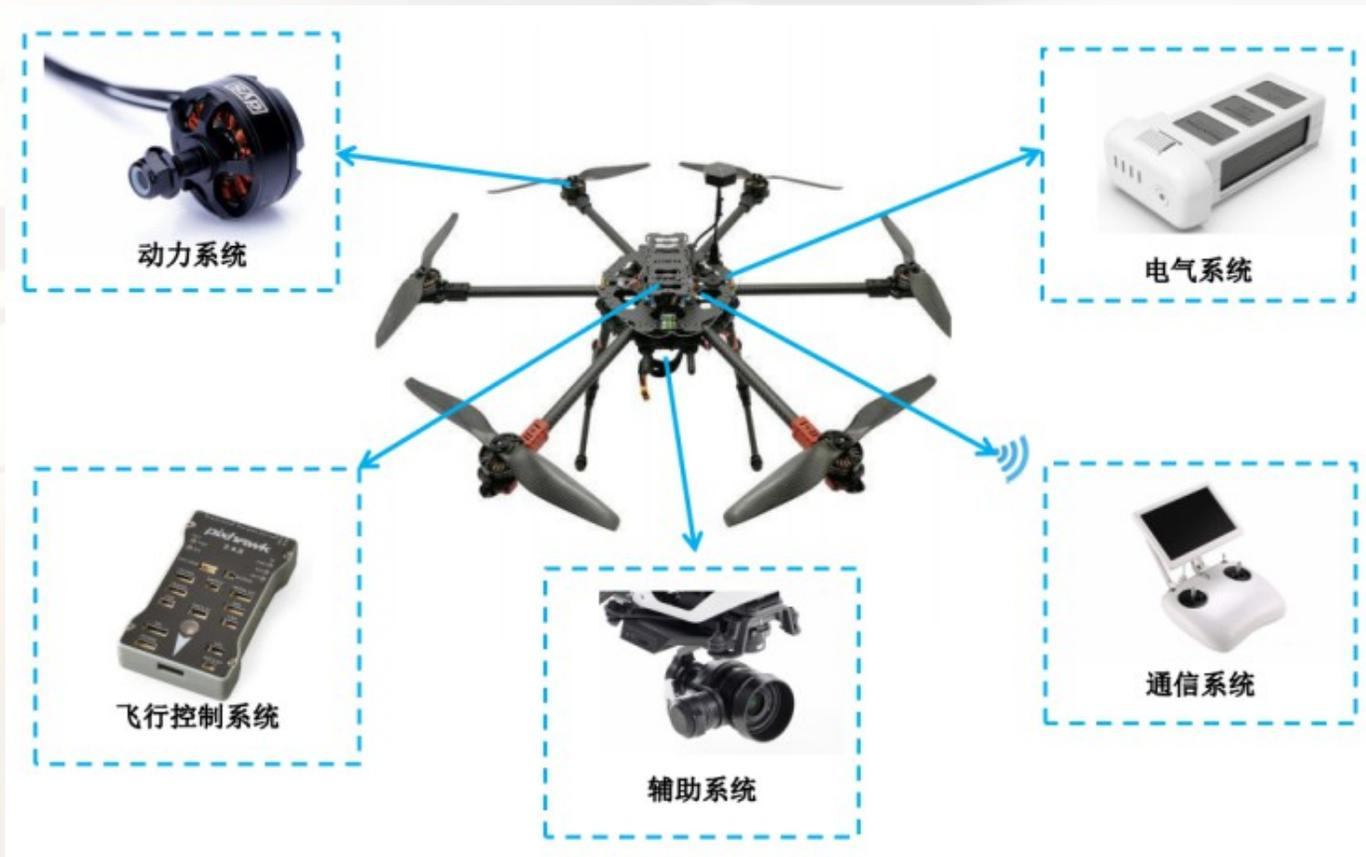
四旋翼无人机系统结构
