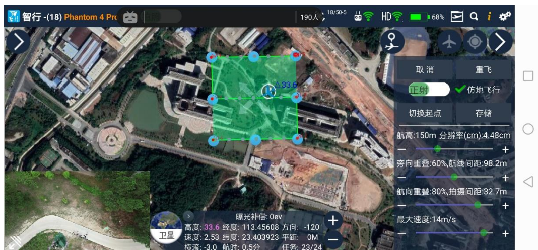
图 6 智行无人机航线规划飞行软件无人机航线规划飞行软件
